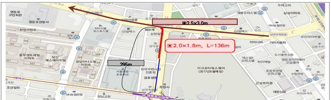
영등포구 영동초등학교 주변 일대는 집중호우 시 통수능 부족에 따른 노면수 침수로 인한 교통 불편이 있고 노후 구배불량으로 침하로 인한 민원이 자주 발생되고 있어 통수능력을 향상시키고자 기존의 하수관로를 개량하여 안전사고 예방과 쾌적하고 편리한 도시환경을 조성코자 함
