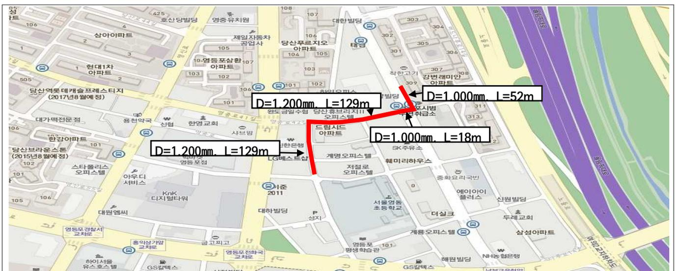
영등포구 선유도역 ~ 롯데제과 주변 일대는 집중호우 시 통수능 부족에 따른 노면수 침수로 인한 교통불편이 있고 노후 구배불량으로 침하로 인한 민원이 자주 발생되고 있어 통수능력을 향상시키고자 기존의 하수관로를 개량하여 안전사고 예방과 쾌적하고 편리한 도시환경을 조성코자 함
