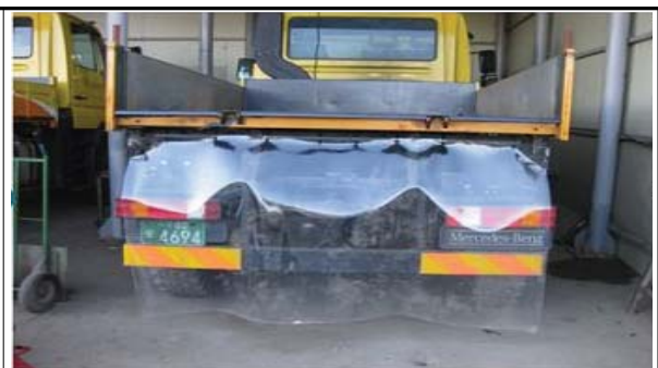
후미 차단막 설치 후
