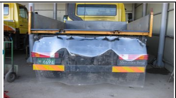
후미 차단막 설치 후
